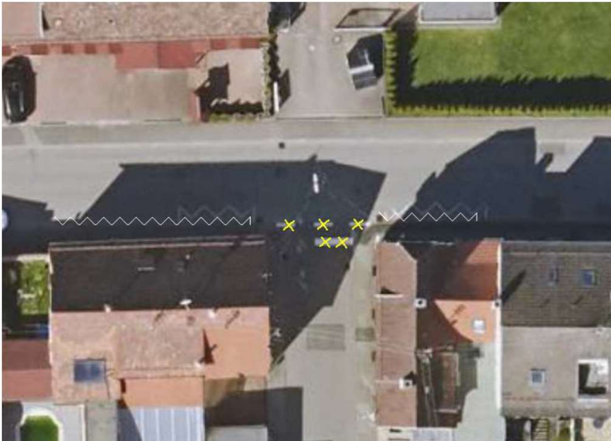
Abbildung 5: Einmündung Flurstraße mit verlängerter Grenzmarkierung und zu entfernender Markierung
