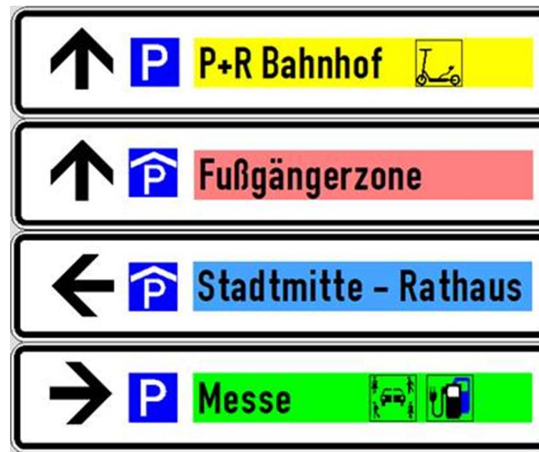
Abbildung 13: Beispielhafte Darstellung der Beschilderung und Zonierung des Parkleitsystems
