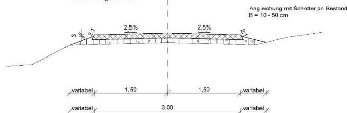
10 cm Asphalttragdeckschicht AC 16 TD
